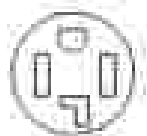
4 wire receptacle (14-30R)
