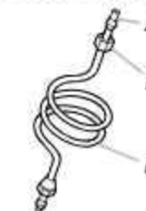
A. Bague de compression B. Écrou de compression C. Tube en cuivre
